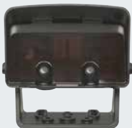
Радарный датчик движения MWD-C Быстрое и целенаправленное автоматическое открытие ворот, распознавание направления, макс. высота монтажа 7 м, монтаж в морозильных камерах возможен максимум до -22°C, класс защиты корпуса IP 65
